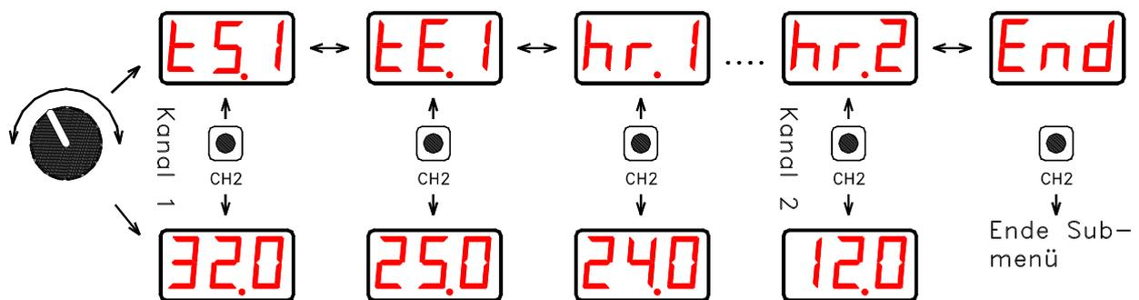
Zu beachten ist, dass der programmierte Startwert immer größer sein muss als der Endwert. Sollten die Werte nicht korrekt programmiert sein ( $tS.. \leq tE..$ ), kann der Timer nicht gestartet werden. Die Regelung erfolgt dann weiterhin nach dem Wert  $tE..$
